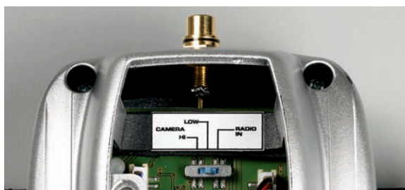
Selettore uscita telecamera (livello low o high) o ingresso radio. Camera OUT (low or high level) Radio IN switch.
