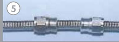
Placer l'olive sur le tuyau et pousser sur une surface plane afin de l'enfoncer au maximum dans son logement.
